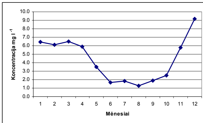
4 pav. 1996–2005 m. vidutinė nitrato azoto, išplauto į Graisupio upelį koncentracijų kaita kiekvieną mėnesį
