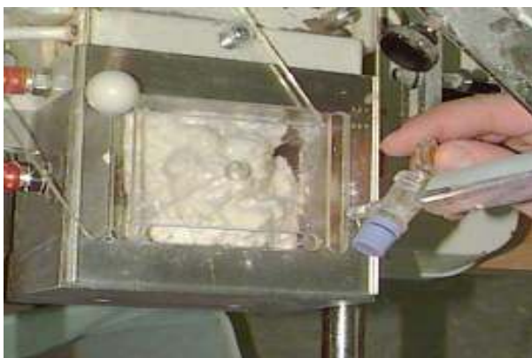
4 pav. Farinografijos metodas: vandens pylimas ir nubraižyta kreivė
