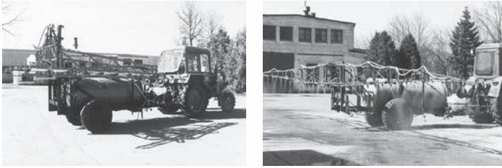
9 pav. Seno naudojamo purkštuvu veikimas prieš ir po pertvarkymo (išorinės techninės buklės ir išpurkšto tirpalo kiekio skersinio pasiskirstymo tolygumo palyginimas)
