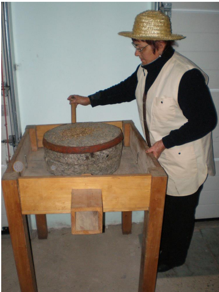
1 pav. Salyklo malimas rankinėmis sukamosiomis akmens girnėmis
