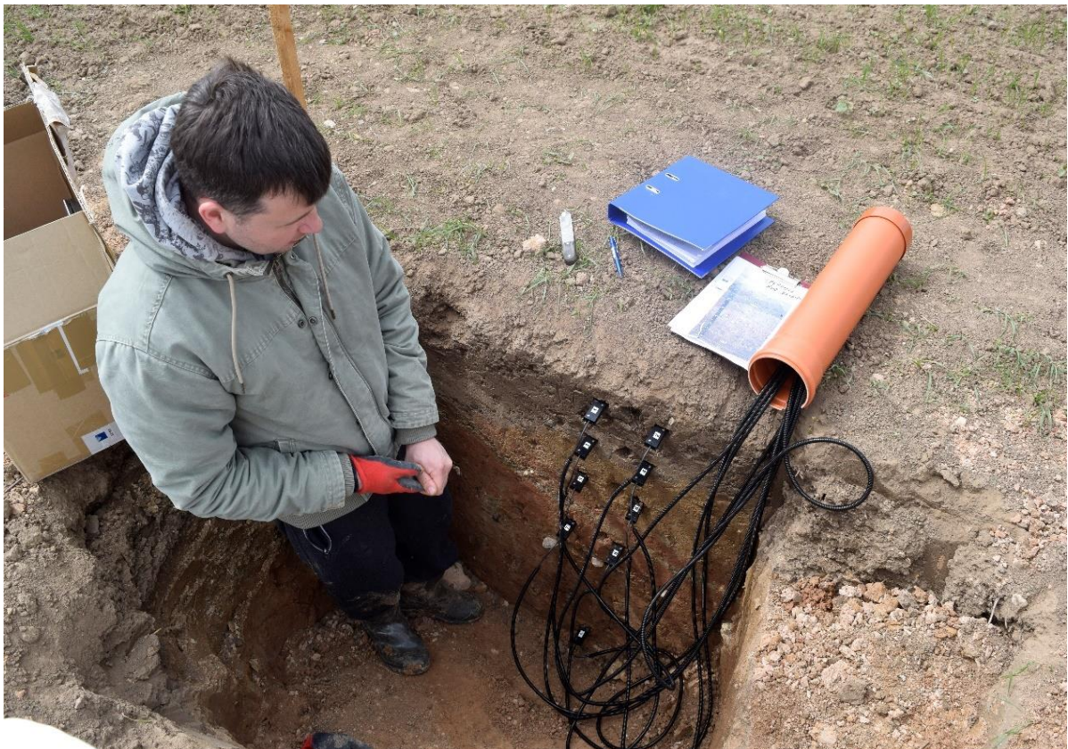
8 paveikslas. Stagniškame išplautžemyje įdiegta SoilNet temperatūros ir drėgmės įranga.
