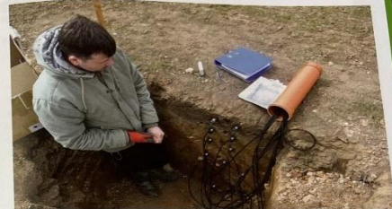
Stagnikame liplautžemyje įdiegta SoilNet (ranga, kuri kas valandą matuoja dirvožemio temperatūrą ir drėgmę skirtinguose dirvožemio horizontuose (iki 1,2 metro gylio))
