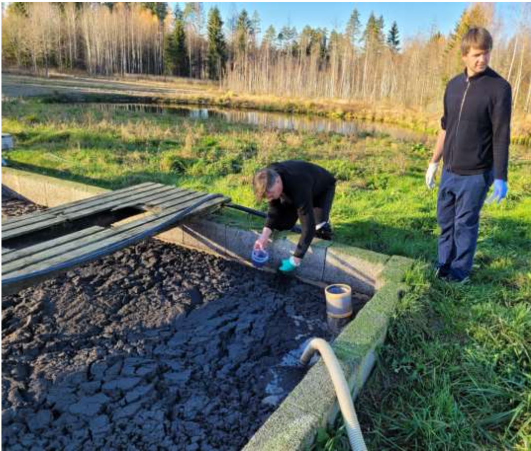
3.7 pav. Imamas dumblo mėginys iš sėdintuvo, kur surinktas ir sutankėjęs būgninio filtro praplovimo vanduo, paveiktas koaguliantų
