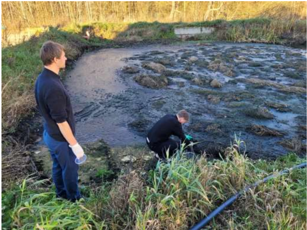
3.9 pav. Mėgininio ėmimas iš dumblo kaupimo ir nusausinimo rezervuaro
