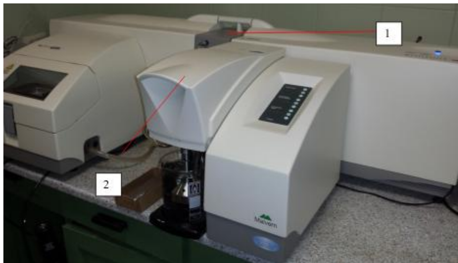
2.3.3 pav. „Mastersizer 2000 Hydro 2000 Mu“: 1– optinis blokas; 2 – ėminio sklaidos įrenginys (nuotrauka A. Adamavičienės)
