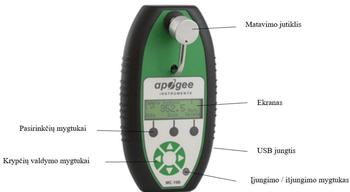
2.3.8 pav. Chlorofilo koncentracijos matavimo prietaisas MC-100 ( https://www.apogeeinstruments.com ) (K. Romanecko nuotrauka)
