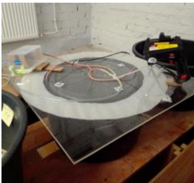
4 paveikslas. Dujų koncentracijų matavimai mėšlo rezervuaruose
