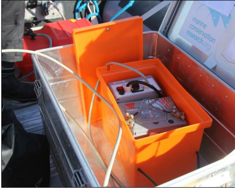
6 pav. Akumuliatoriais užmaitinamos akustinės atbaidymo priemonės vandeniui atspari talpa, į kurią talpinamas akumuliatorius ir valdymo mechanizmas ( https://www.marineconservationresearch.co.uk/ ).
