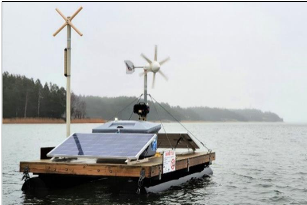
5 pav. Saulės ir vėjo energija maitinamos akustinės atbaidymo priemonės ( angl. acoustic deterrent devices, ADD ) (Lehtonen ir kt., 2022)
